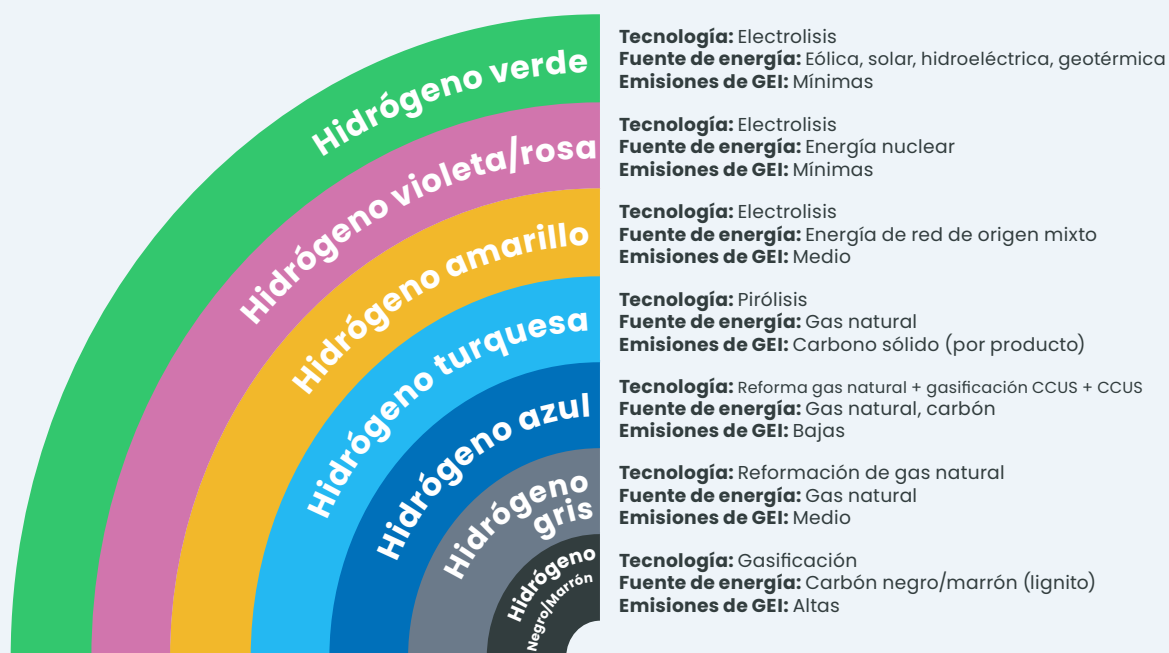
Figura 5: El arcoíris del hidrógeno
